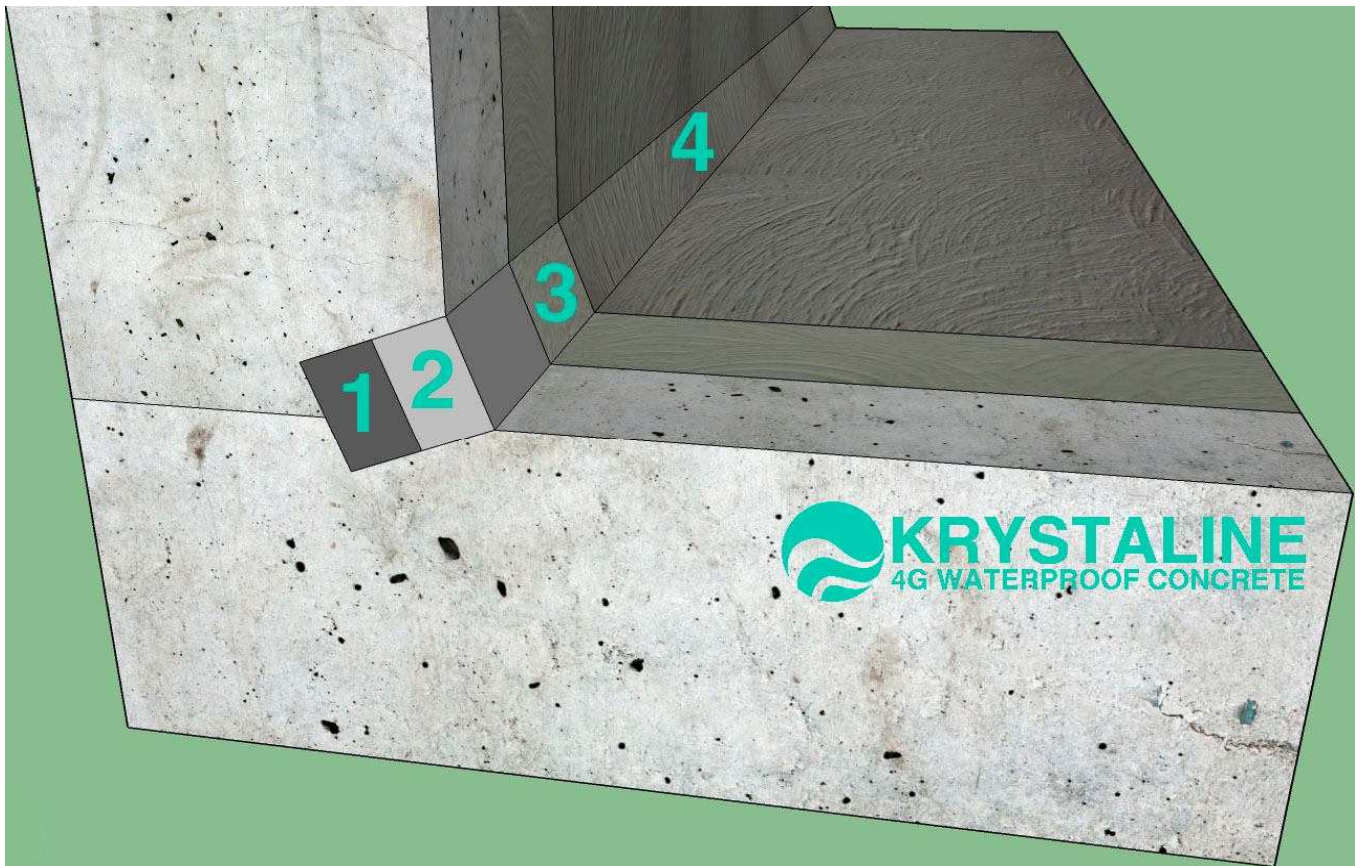
Rys. 2. Przykładowy układ warstw w przypadku uszczelnienia styku ściana- płyta denna: - w przypadku aktywnego wyciekania wody: (1) KRYSTALINE PLUG (2) KRYSTALINE 1 (3) KRYSTALINE 1 (4) KRYSTALINE 2 - bez aktywnego wyciekania wody: (1) KRYSTALINE 1 (2) KRYSTALINE BLOCK lub KRYSTALINE BLOCK F (3) KRYSTALINE 1 (4) KRYSTALINE 2
